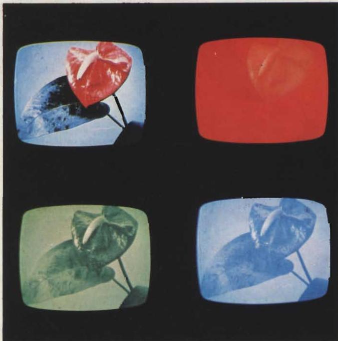
Fig. 19 - La ricezione da parte di un televisore in bianco e nero di qualunque di queste tre componenti di colore primario non permetterebbe di riprodurre una fedele copia bianco e nero dell'immagine a colori trasmessa (a sinistra in alto).
