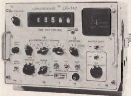
Fig. 13 - Ricevitore LORAN, modello LR 747, per la ricezione dei canali A e C. Indicazione digitale ad inseguimento automatico.
